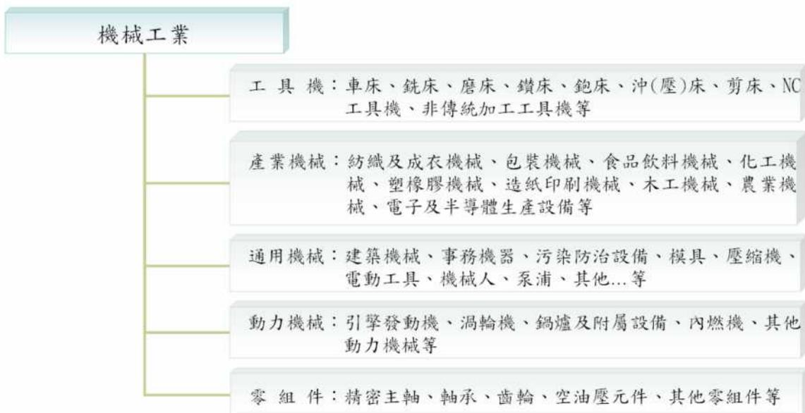
工具機 (Machine Tool) 根據國際標準機構 (International Organization for Standardization, 簡稱 ISO) 與美國工具機博覽會 (International Manufacturing Technology Show, 簡稱 IMTS) 對工具機之綜合定義為：「一種利用動力驅動且無法以人力攜帶的設備，藉由切削、衝擊等物理、化學或其他方法的組合，以達到加工物料目的之機器皆可定義為工具機。」即指動力機械製造裝置，通常用於精密切削金屬以生產其他機器或加工之金屬零件。在廣泛的定義下，所有不是倚賴人力用以加工的工具都可以泛稱為工具機，也可以說是運用在製造業上的一種動力驅動的固定式機械裝置，可以用來將金屬或其他材料加工成所需的零件形體。在工業製程上的工具機主要可區分為金屬切削、金屬成形這兩大範圍，而不同種類的工具機可以根據刀具、運動方式的不同，而完成不同零件加工需求。金屬切削的功能是將金屬材料除去，包括車床、鑽床、銑床與非傳統加工工具機等。金屬成形則是將金屬塑造成某一形狀有壓床、液壓壓床等。
